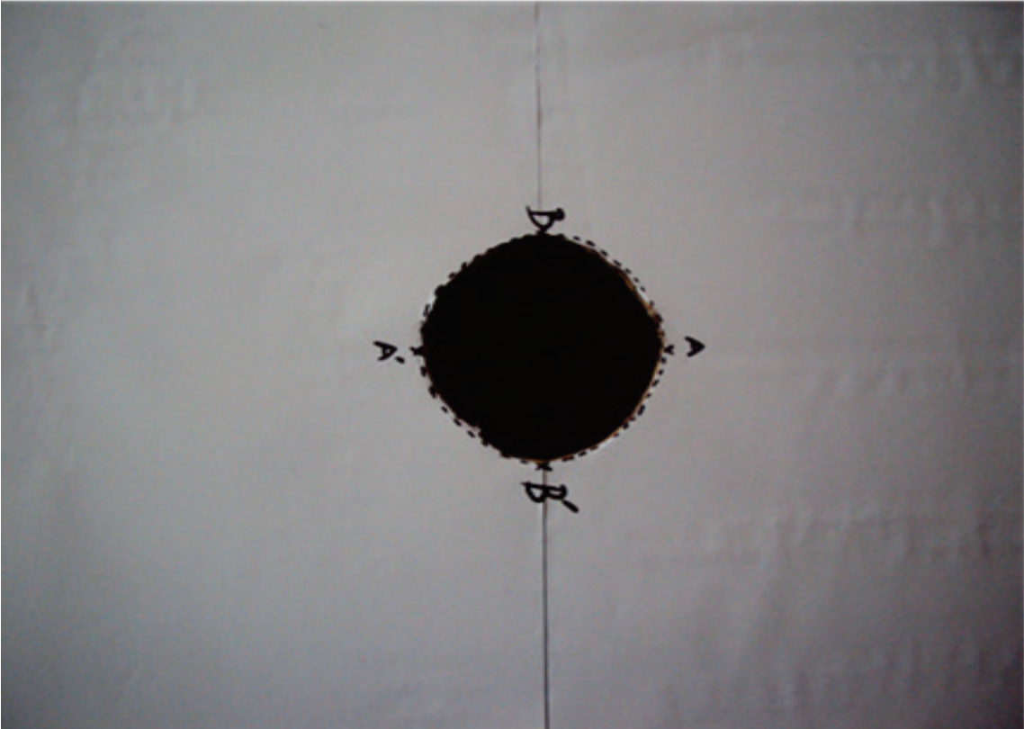
Maket Üzerinde Oluşturulmuş Defekt
